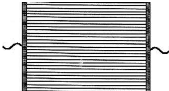
Dirección de las líneas de flujo entre las dos placas iguales dispuestas paralelamente
